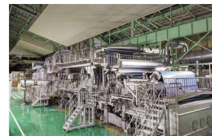
高岡工場 N6号マシン 生産品種：ティッシュ原紙、ペーパータオル原紙、トイレットペーパー原紙 生産能力：約22,000t/年
