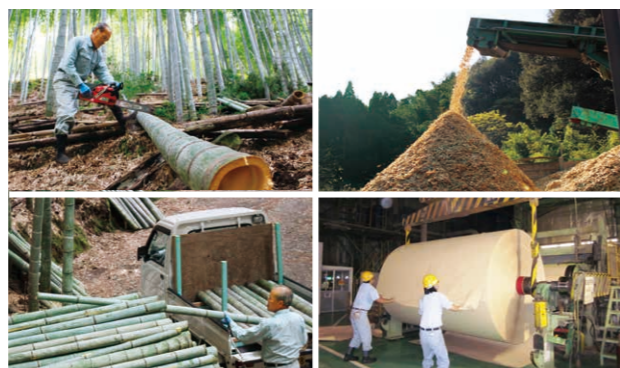
伐採者が竹をチップ工場へ自ら運搬、竹チップから製紙工程を経て竹紙が完成
