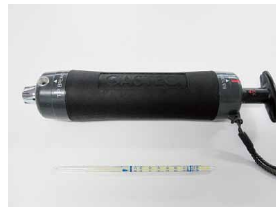
検知管による臭気手分析
