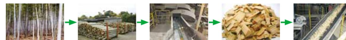
竹パルプ製造工程から得られる黒液（廃液）は、回収ボイラの燃料として全て利用されています。
