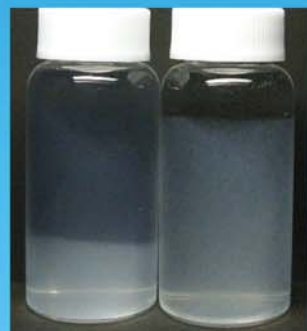
NC分散水（左）とナノ複合体分散水（右）の比較。共にNC含有量は0.05 wt%。
