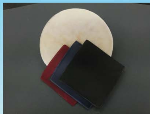
円形状のNC成形体(直径15cm)& 着色した角板状のNC成形体(9.5cm角)
